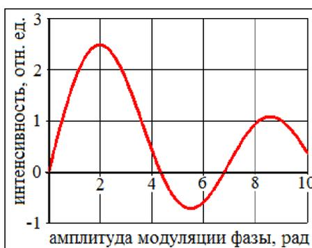
Рис. 45. Зависимость чувствительности управляющей системы от амплитуды модуляции фазы.
